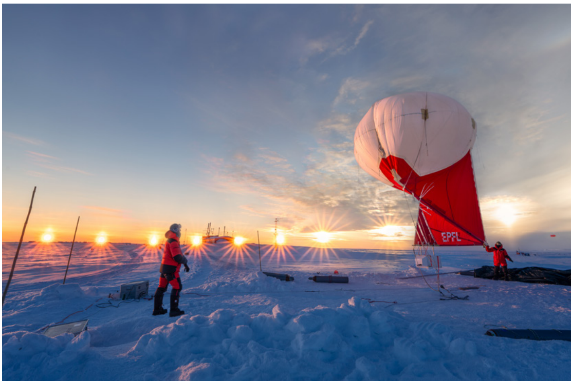
Mit einem Fesselballon machte das Team um Julia Schmale im Frühjahr 2024 Messungen von Aerosol-Wolken-Wechselwirkungen auf der Forschungsstation Villum in Nordgrönland (82°N).
