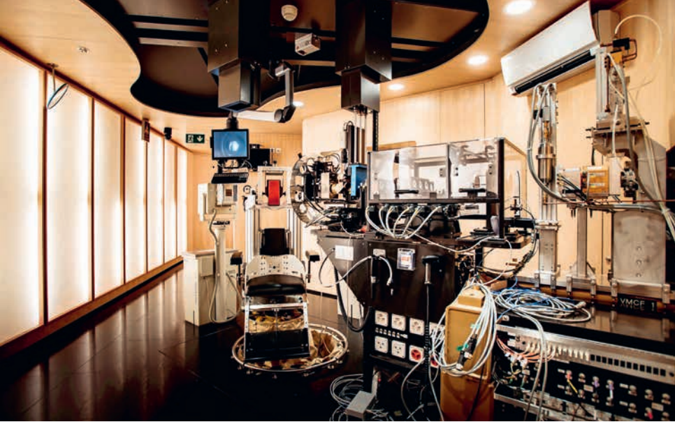
OPTIS2, l'installation thérapeutique de traitement des tumeurs oculaires, était développée à base de l'unité d'irradiation OPTIS. (Photo: Mahir Dzambegovic/PSI)
