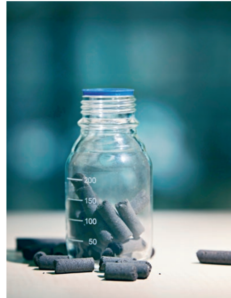
Les perspectives économiques des pellets obtenus à l'Eawag à partir de boues fécales déshydratées et employés comme combustibles sont excellentes, même pour les pays du Sud (cf. p. 32 s).
