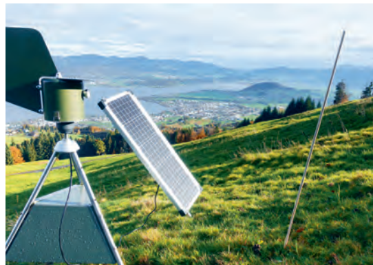
Automatische Sporenfallen filtern Sporen aus der Luft. › Markus Schlegel / WSL
